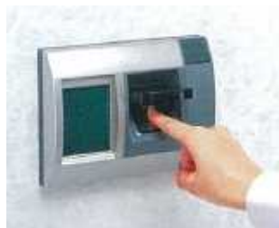
出入管理システム
